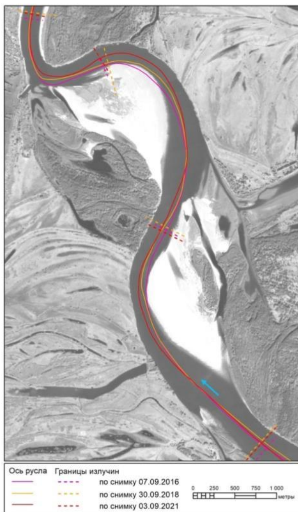
Рисунок 1.10 – Геометрическая ось русла и границы излучин р. Обь в районе водозабора №2, построенные по спутниковым снимкам разных лет (рисунки 1.7, 1.9)
